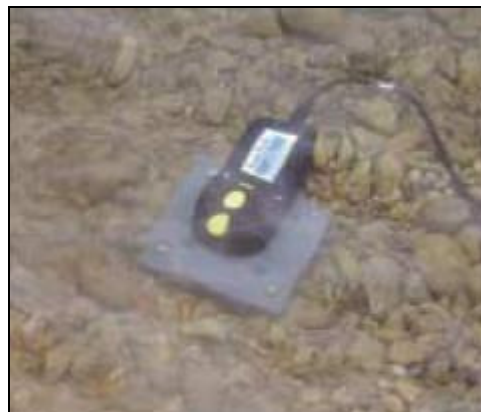
Figure 4: vélocimètre (principe Doppler acoustique)
