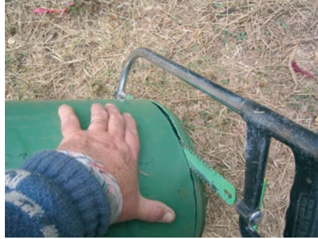
Photo 6-8 : Découpage de la base du seau.
