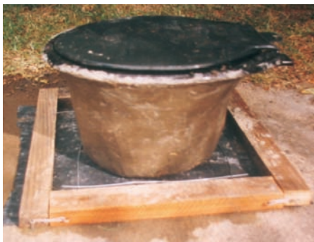
Photo 5-11 : Siège finalisé placé dans un moule de bois.
