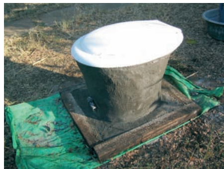
Photo 6-24 : Siège finalisé en durcissement
