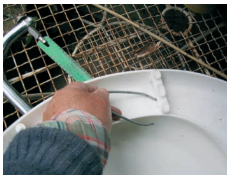
Photo 6-15 : Utilisation d'un fil de fer chaud pour percer les supports du siège de la latrine
