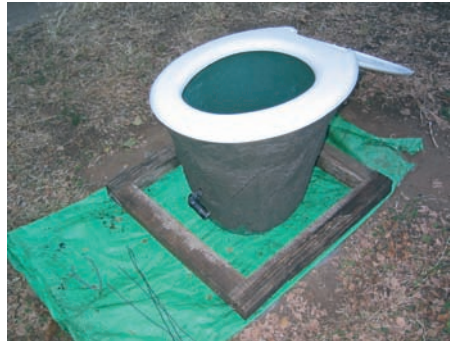
Photo 6-22 : Seau et siège retournés et placés dans un moule de base
