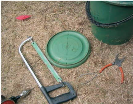
Photo 6-9 : Marquage de la base en plastique
